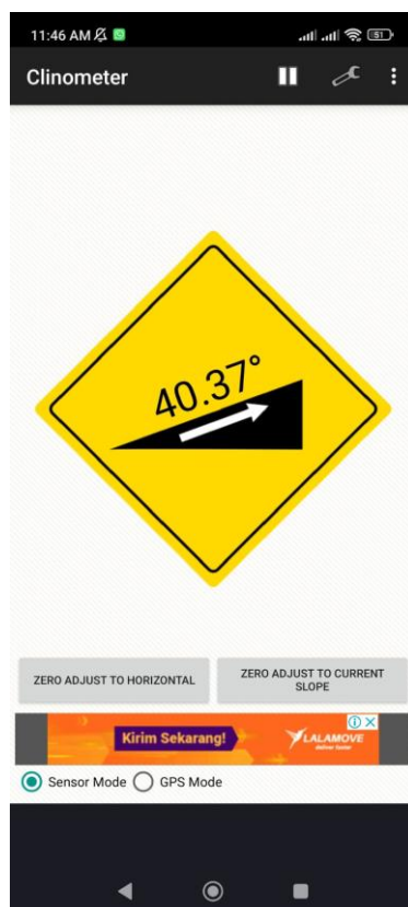
Gambar 3. Aplikasi Clinometer yang Digunakan
